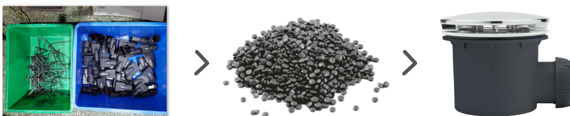
Ex: Carottes d'injection de plastique rebroyées et réutilisées dans la production.
